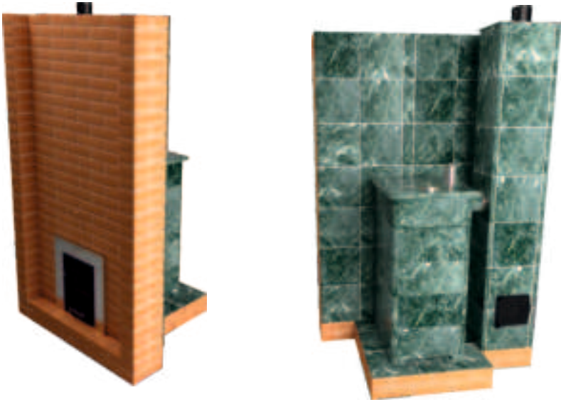
Рис. 7 Пример установки печи с отдельно стоящим дымоходом
