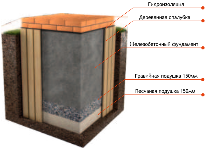
Рис. 3 Схема устройства фундамента
