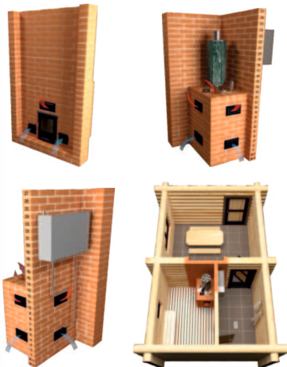
Рис. 8 Пример установки печи в кирпичном кожухе с функцией обогрева комнаты отдыха и моечного отделения
