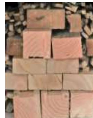
Рис. 8.2.1 Укладка дров в топке.
