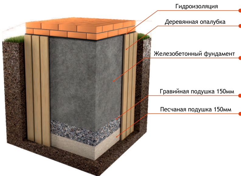
Рис. 3 Схема устройства фундамента
