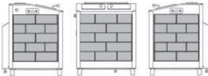
Рис. 11.2 Схема установки декоративных плит каменной облицовки для ЭНУ 18-24 кВт
