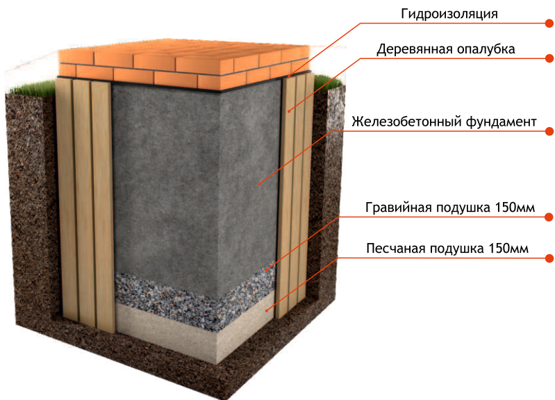
Рис. 3 Схема устройства фундамента
