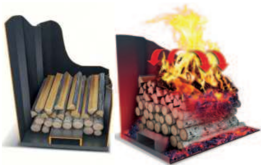
Рисунок 9.5. Варианты закладки дров в топку печи.
