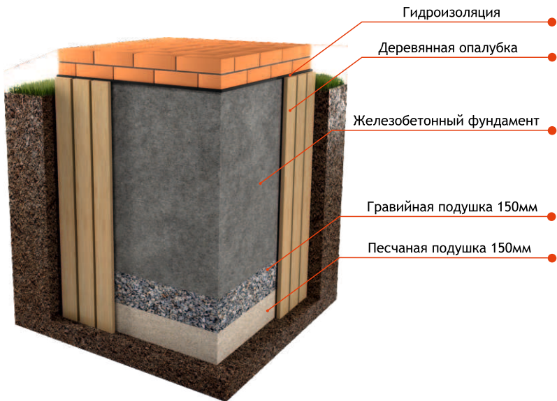
Рис. 3 Схема устройства фундамента
