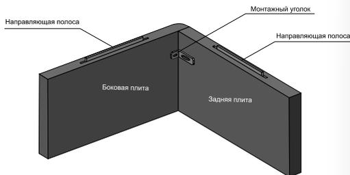
Рис. 6 Расположение монтажного уголка и металлических полос
