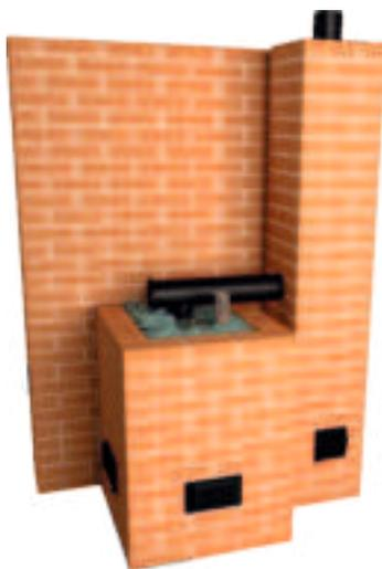
Рис. 11 Пример установки печи в кирпичном кожухе с отдельно стоящим ДЫМОХОДОМ
