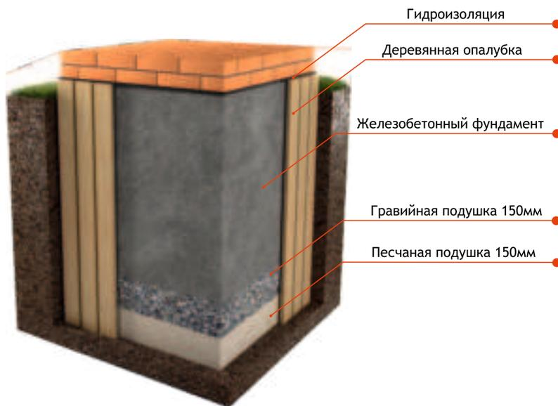
Рис. 3 Схема устройства фундамента
