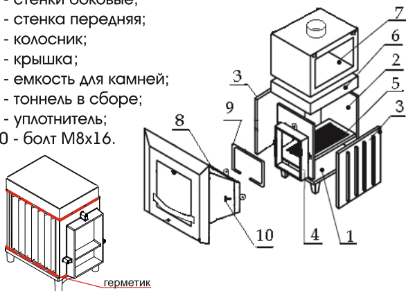
Рис. 2. Схема сборки топочного агрегата
