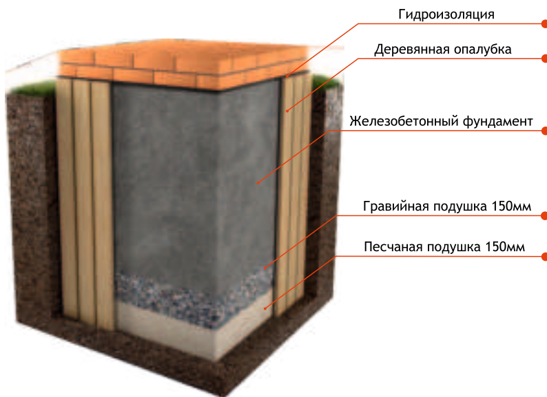
Рис. 3 Схема устройства фундамента
