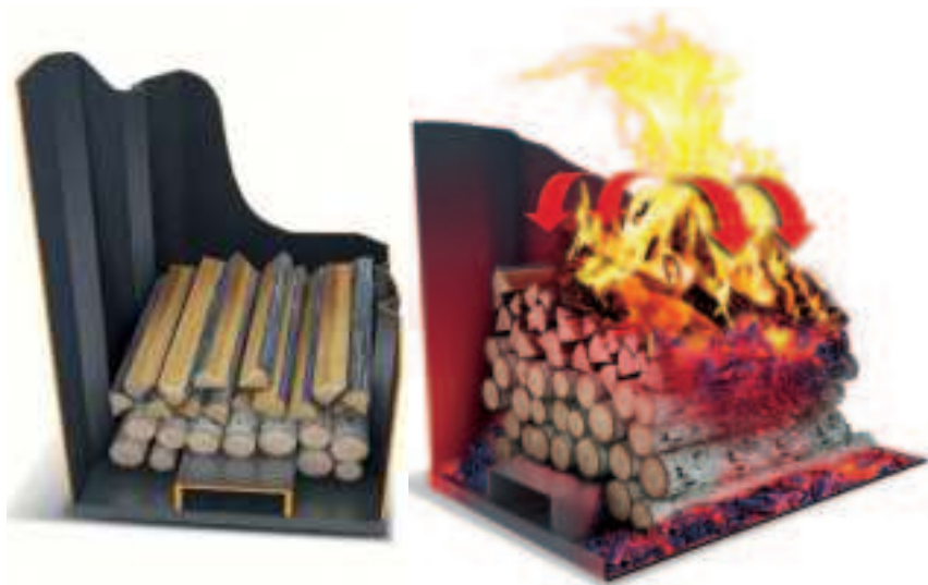
Рисунок 9.5. Варианты закладки дров в топку печи.
