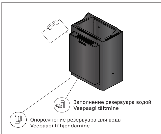
Рисунок 2. Опорожнение резервуара для воды Joonis 2. Веерааги тühjendamine
