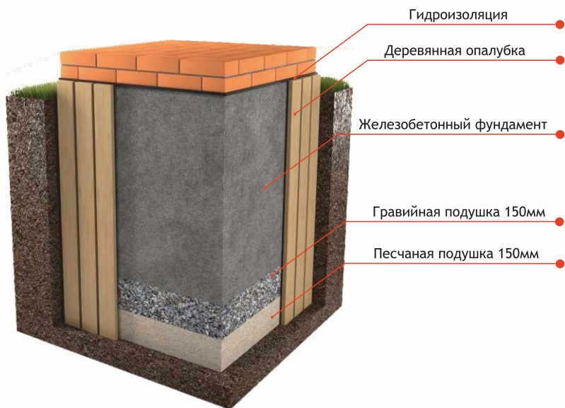
Рис. 3 Схема устройства фундамента
