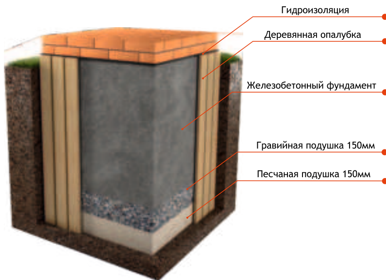
Рис. 3 Схема устройства фундамента
