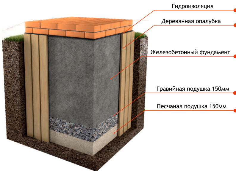
Рис. 3 Схема устройства фундамента
