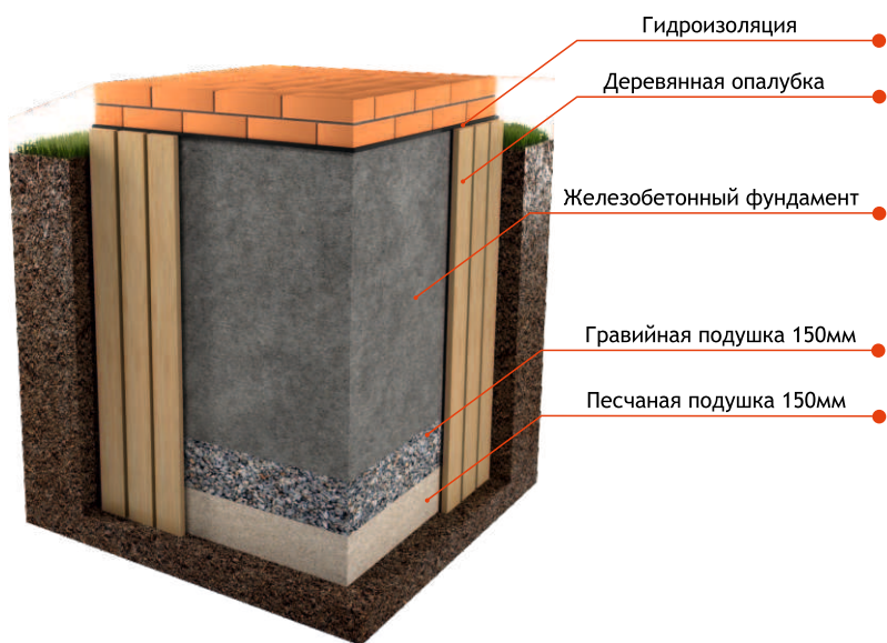
Рис. 3 Схема устройства фундамента
