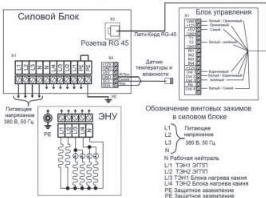
Рис. 6.3 Схема соединений ЭНУ и ПУ 10,0; 12,0; 16,0 кВт
