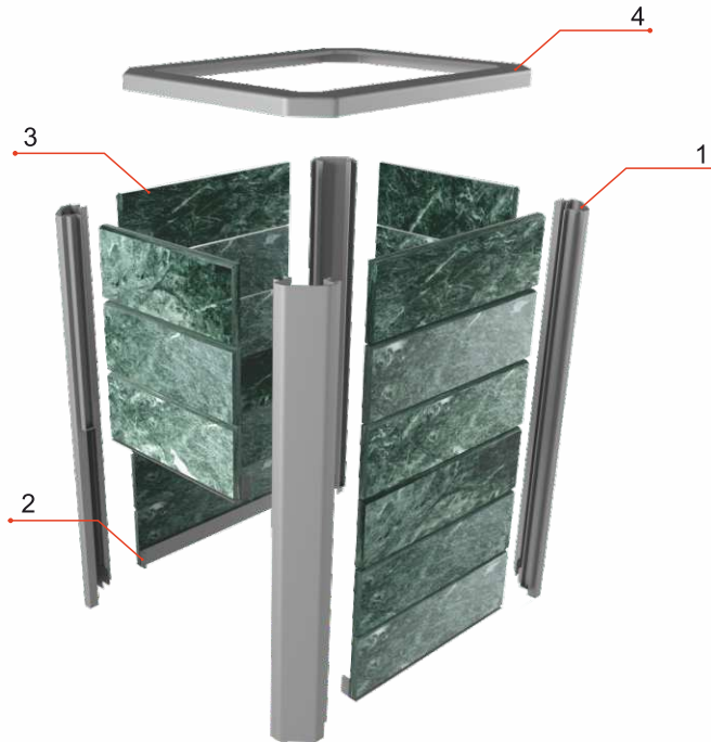
Рис. 4 Схема сборки защитного кожуха
