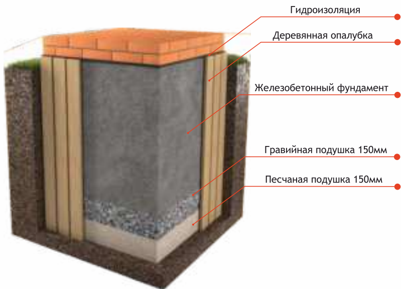
Рис. 3 Схема устройства фундамента
