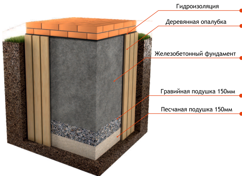
Рис. 3 Схема устройства фундамента
