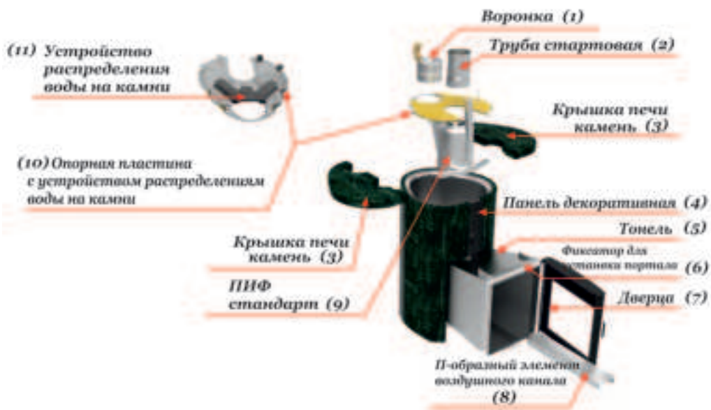
Рисунок 8.3. Схема сборки печи
