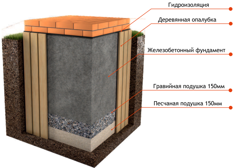
Рис. 3 Схема устройства фундамента
