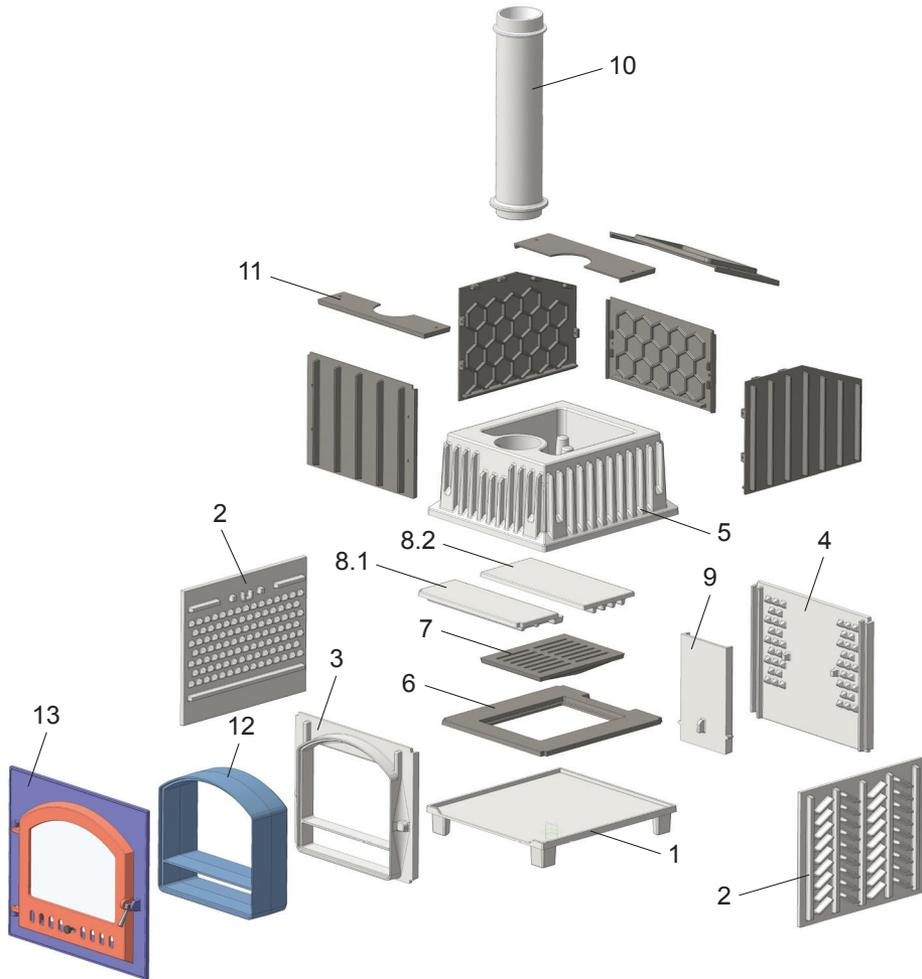
1 – основание; 2 – стенка боковая (2 шт.); 3 – стенка передняя; 4 – стенка задняя; 5 – каменка; 6 – рамка колосниковая; 7 – решетка колосниковая; 8.1 – пламегаситель №1; 8.2\* – пламегаситель №2; 9 – воздушник; 10 – труба стартовая; 11 – короб каменки в сборе; 12 – удлинитель портала; 13 – портал с дверцей в сборе.
