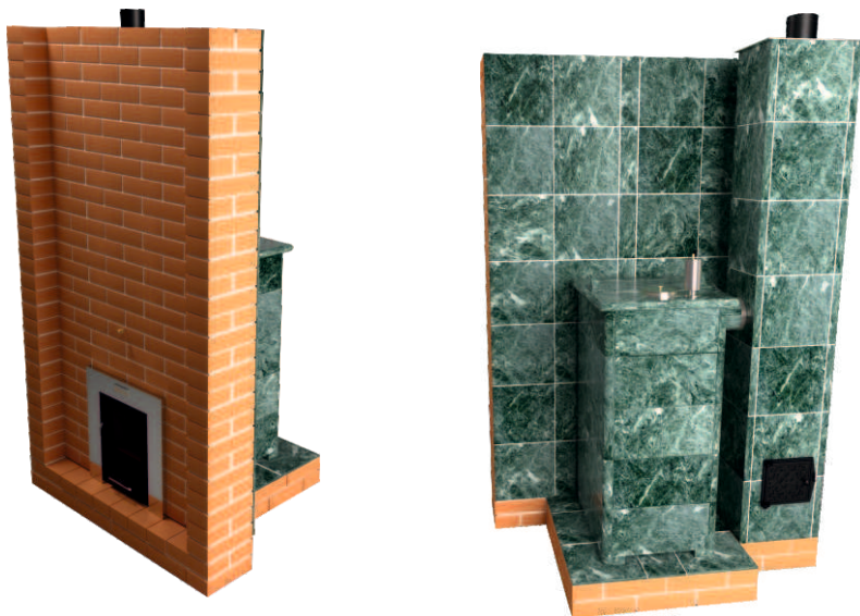
Рис. 7 Пример установки печи с отдельно стоящим дымоходом
