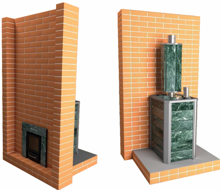
Рис. 3 Проход топочного канала
