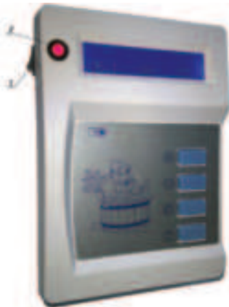
Рис.10. Электронный блок ПУ-01 МП
