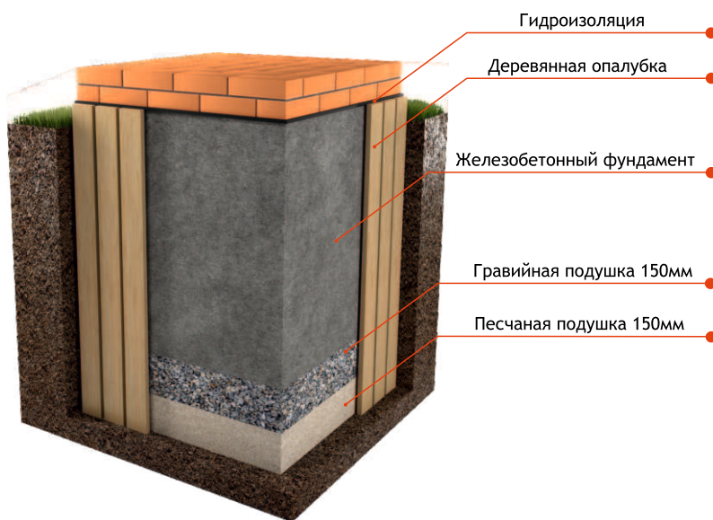
Рис. 3 Схема устройства фундамента
