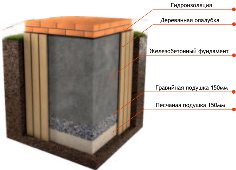
Рис. 3 Схема устройства фундамента
