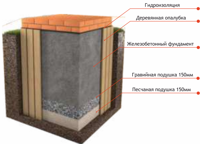
Рис. 3 Схема устройства фундамента
