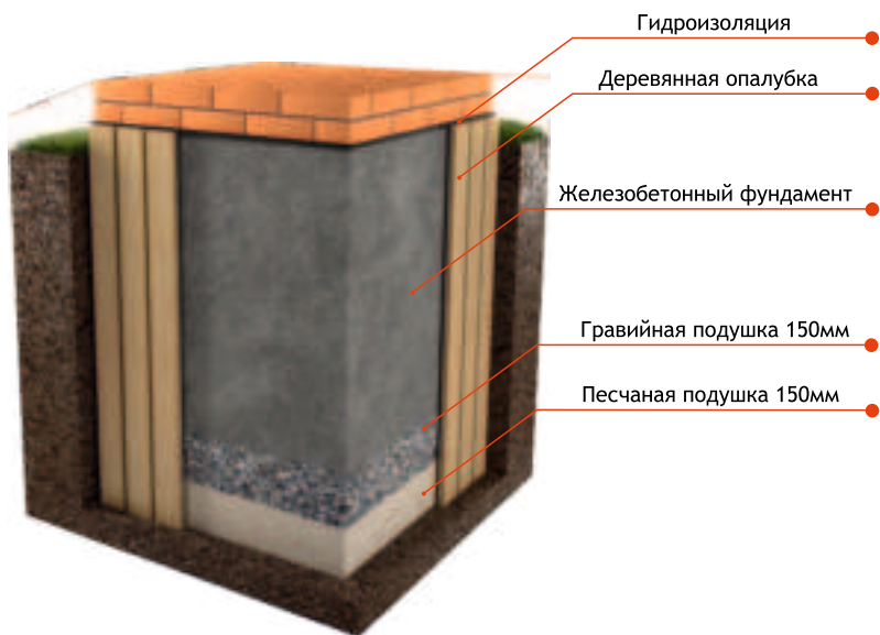
Рис. 3 Схема устройства фундамента
