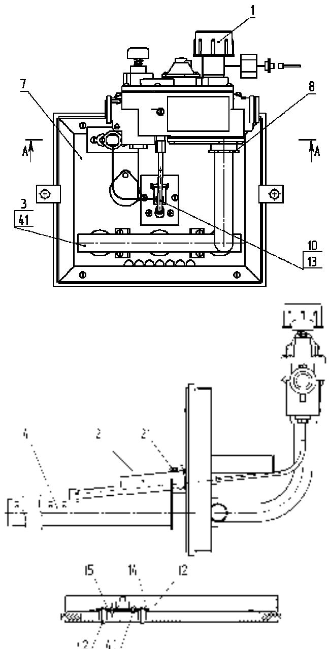
1-блок управления; 2-блок запальника; 3-коллектор; 4-труба горелочная; 7-панель;
