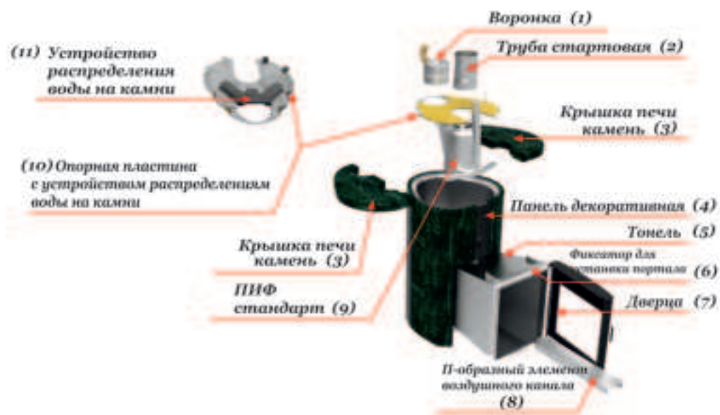
Рисунок 8.3. Схема сборки печи
