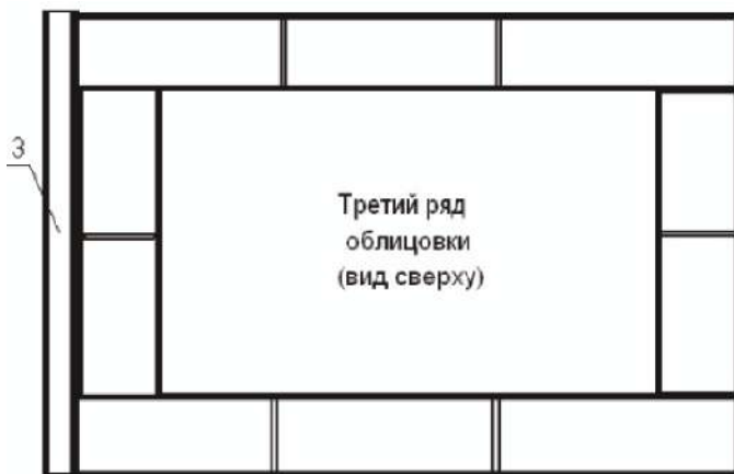
Рис. 2в. Схема сборки третьего ряда облицовки
