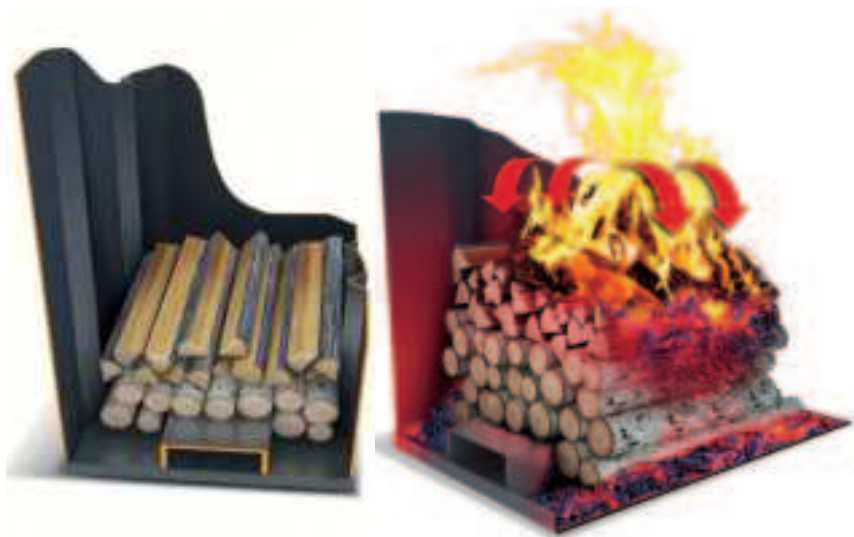
Рисунок 9.5. Варианты закладки дров в топку печи.
