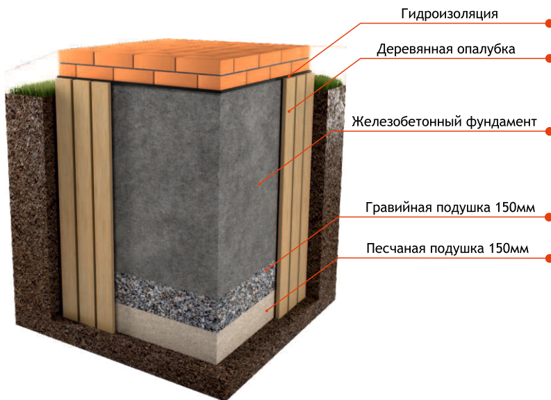
Рис. 3 Схема устройства фундамента
