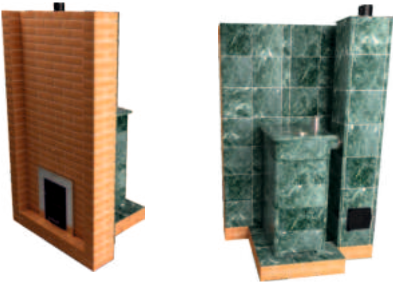
Рис. 7 Пример установки печи с отдельно стоящим дымоходом
