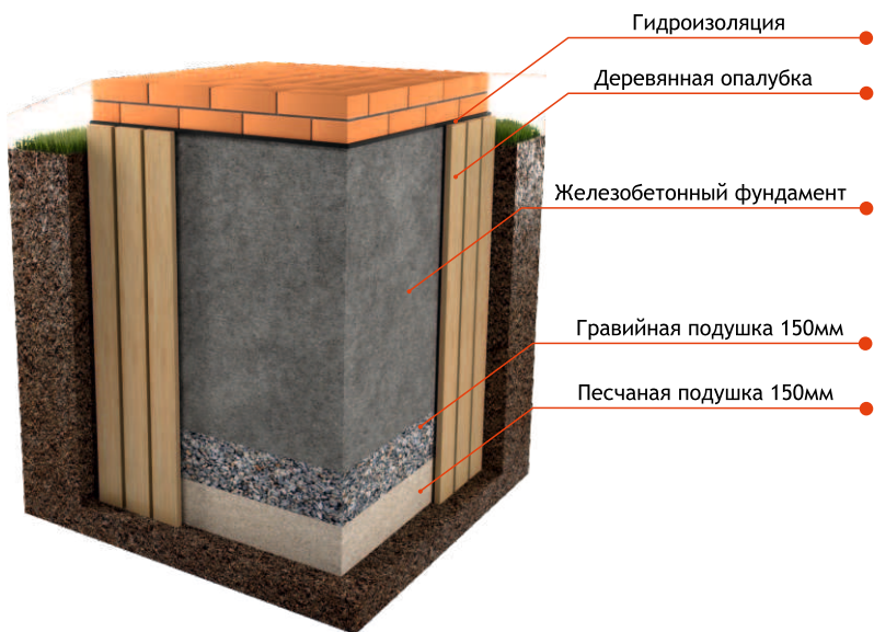
Рис. 3 Схема устройства фундамента
