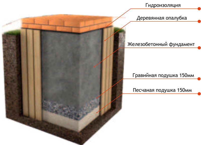
Рис. 3 Схема устройства фундамента
