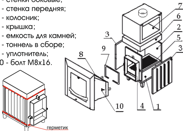
Рис. 2. Схема сборки топочного агрегата
