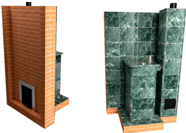
Рис. 7 Пример установки печи с отдельно стоящим дымоходом
