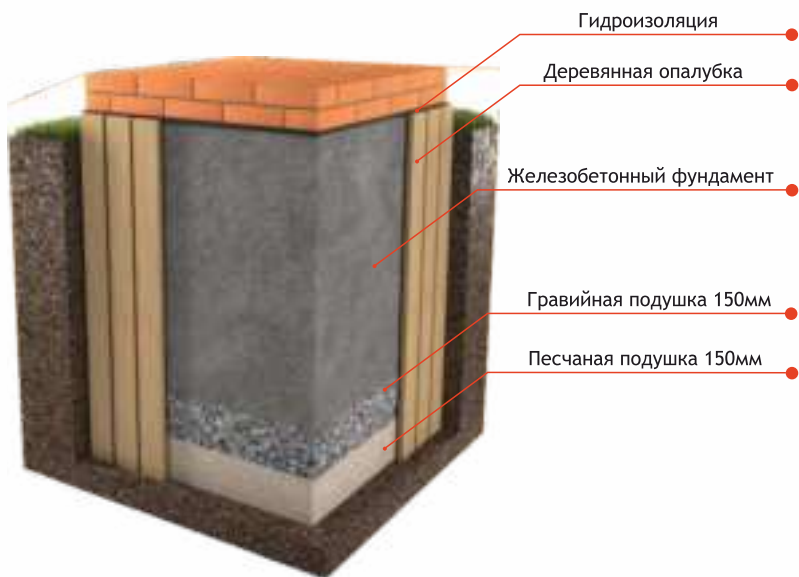
Рис. 3 Схема устройства фундамента
