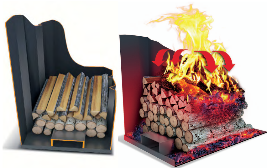
Рисунок 9.5. Варианты закладки дров в топку печи.
