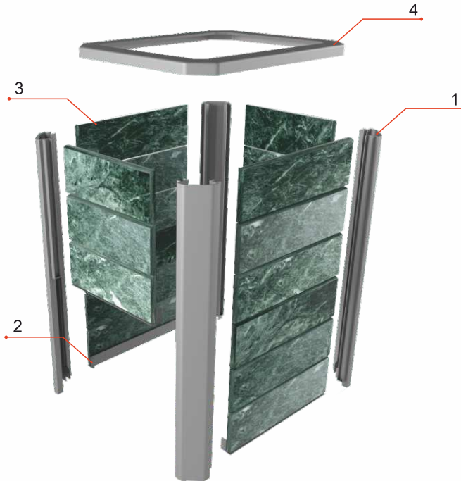
Рис. 4 Схема сборки защитного кожуха
