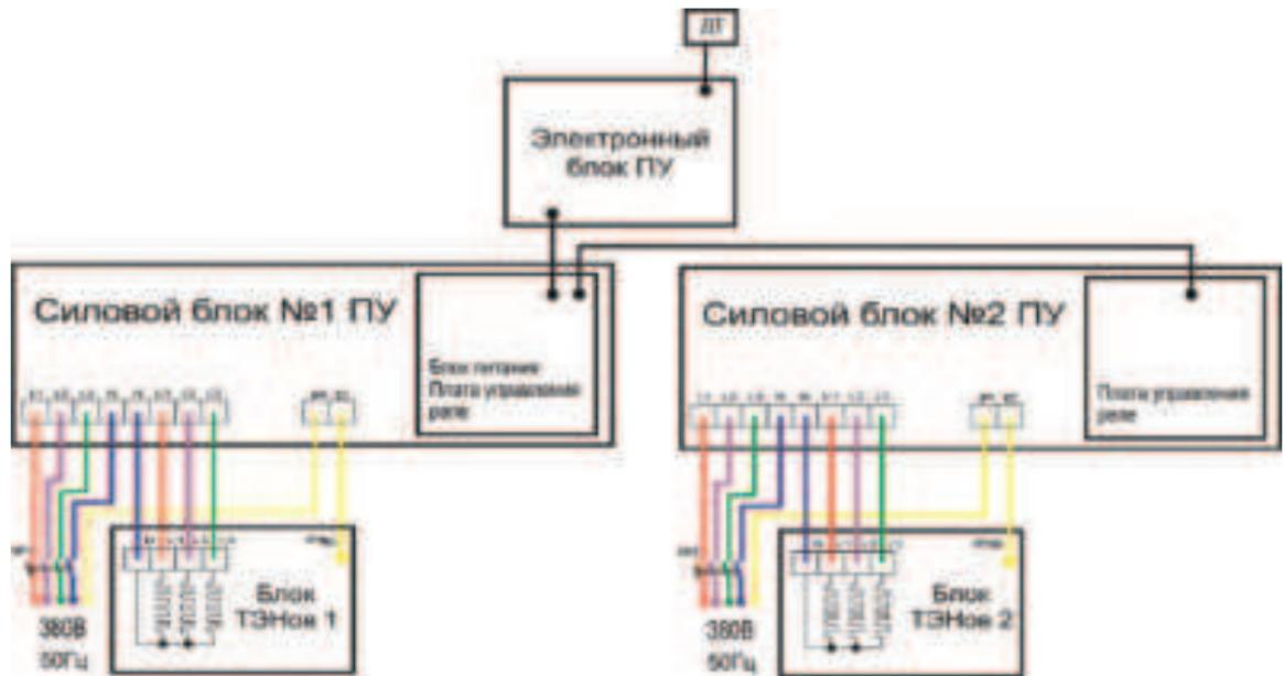
**Схема 1.1** Подключение Устройства к электрической сети двумя автоматическими выключателями.
