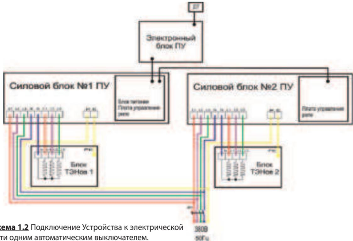
**Схема 1.2** Подключение Устройства к электрической сети одним автоматическим выключателем.
